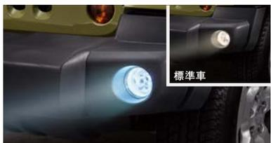
低消費電力と長寿命を実現するLEDフォグランプ。クリアでシャープな輝きを放ち、悪天候時の視界を確保します。コンバージョンキット(色温度6,000K)。
