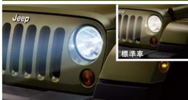
ハロゲンランプに比べて2倍明るいホワイト光(色温度4,300K)で、より速く広い範囲を照らします。夜間でのクリアな視界を確保し、より安心感に満ちたドライビングを実現します。
