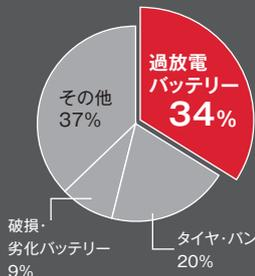
バッテリー上がりの原因は、「過放電」と「破損・劣化」の2つ。夏季のエアコン使用などでバッテリーを酷使していると、秋季にトラブルが発生することがあり注意が必要です。**日頃の定期点検とともに、正規ディーラーでの点検をおすすめします。**
