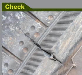
トレッド面、サイドウォール 部分などに切り傷
