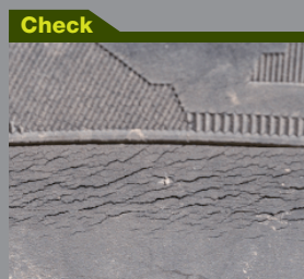
サイドウォール部分に ひび割れや擦り傷
