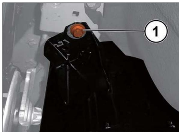
37. 油圧リフトを下げ、HV トラクション・バッテリー①を取り外す。
