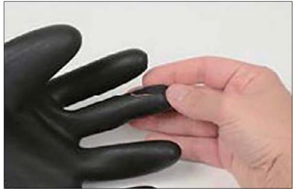
・ゴム製絶縁手袋およびスリーブは、その完全性が損なわれていないことを確認するために、少なくとも 1 日に 1 回は内側と外側の表面を点検する必要がある。この点検は、革製プロテクタを着用せずに使用する場合、または使用中にゴム製手袋が引っ掛かったり、破損したことが疑われる場合は、それ以上の頻度で行う必要がある。
