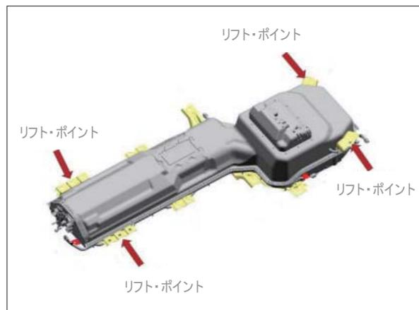
2. 下図のように、出荷用平パレットにバッテリーを配置する。
