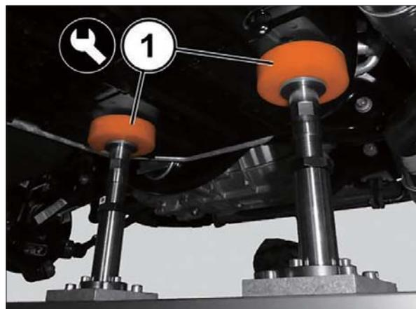
35. HV バッテリーをボディに固定しているファスナ①を取り外す。
